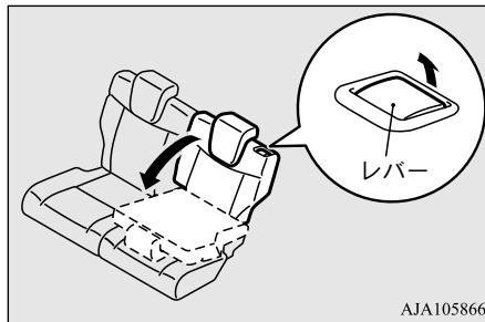
3. リヤシートが一番後ろの位置にあるときは、背もたれを前に倒すとシート後部が浮き上がりますので、シート全体を確実にロックするまでフロアに押し付けます。
