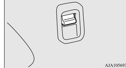
エンジンスイッチまたは電源モードがONのときにスイッチを押し下げるとき、引き上げると閉まります。
