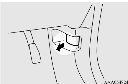
3. エンジンフードのすき間に手を入れ、前端中央部のレバーを左へ押しながらエンジンフードを持ち上げます。
