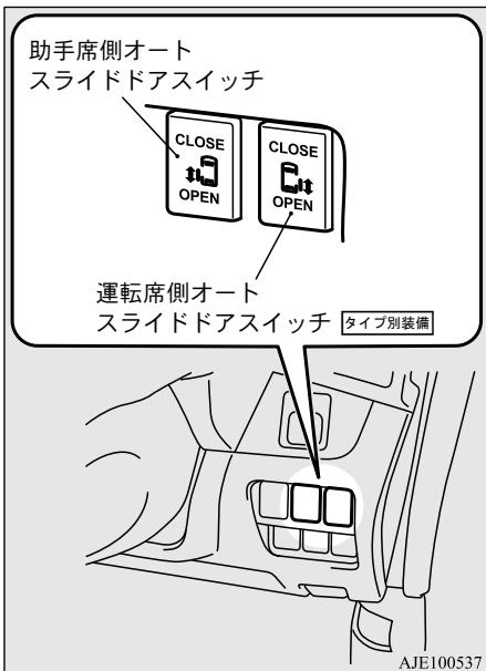
オートスライドドアが全閉位置のときに、オートスライドドアスイッチのOPEN側を約1秒以上押すと警報ブザー
