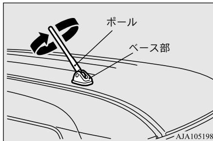
取り付けるときは時計回りにまわしてポールをベース部にねじ込み、しっかりと取り付けてください。
