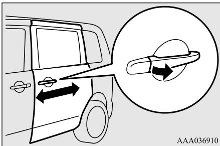
開閉作動中、ドアハンドルを操作すると警報ブザーが3回鳴り、その場で停止します。もう一度、ドアハンドルを操作したときは、停止した前と反対方向に動きます。
