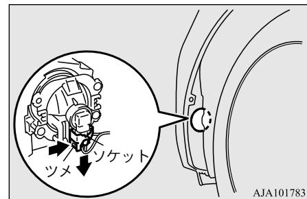
3. バルブを反時計回りに回して外します。
