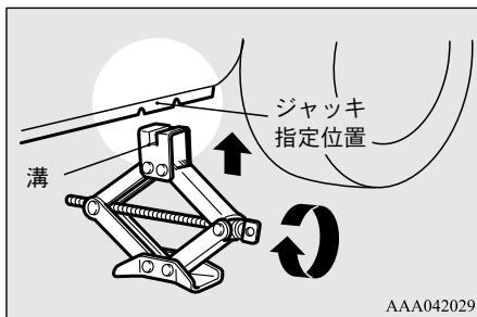
8. 図で示すようにジャッキバーとホイールナットレンチを組み付け、タイヤが地面から少し浮くまで静かにホイールナットレンチを右に回します。
