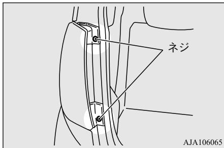
3. ランプユニットを手前に引き、ランプの裏側にある固定ピンとクリップを外します。
