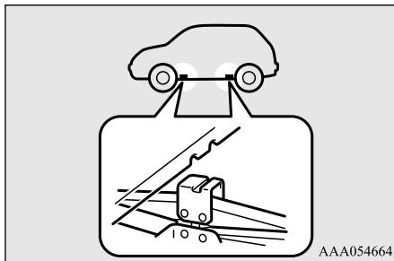
7. ジャッキ頭部の溝がジャッキ指定位置にはまるまで、ジャッキを手で右に回して上げます。
