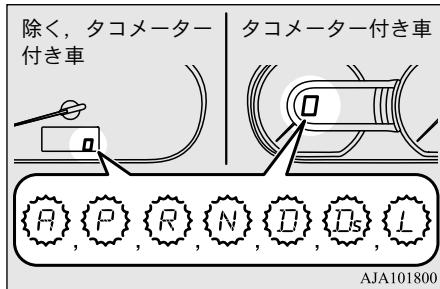
走行中にメーター内のポジションインジケーターが点滅したときは、つぎの方法で処置してください。
