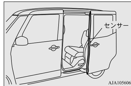
開閉作動中、ワンタッチスイッチを押すと警報ブザーが3回鳴り、オートスライドドアはその場で停止します。
