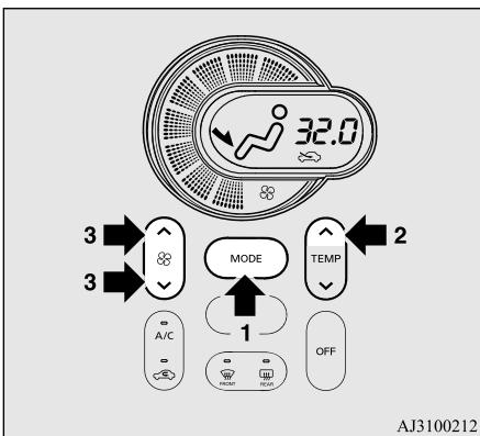
1. 吹き出し口切り換えスイッチで吹き出し口をお好みに設定します。
