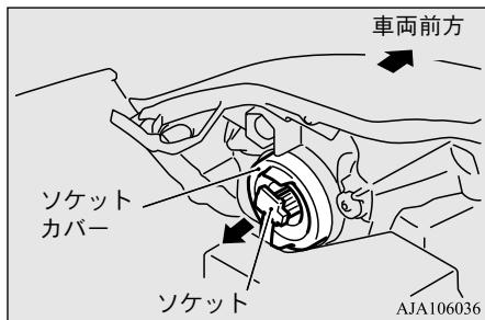
2. 留め金を外し、矢印の方向に引き起こして、バルブを抜き取ります。
