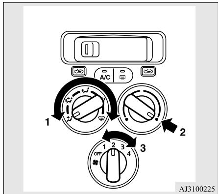
1. 吹き出し口切り換えダイヤルで吹き出し口をお好みに設定します。
