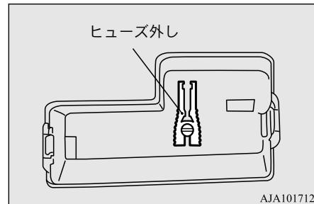
3.ヒューズ外しを使用してヒューズを引き抜きます。ヒューズ外しは、室内のヒューズボックスカバーの内側にあります。
