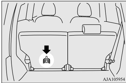
6. テザーベルトのフックをテザーアンカーに掛け、テザーベルトを締めて確実に固定します。
