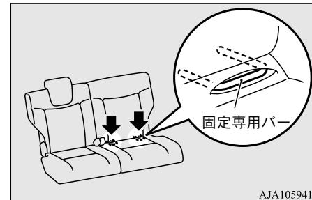
4. チャイルドシートを固定専用バーに取り付けます。
