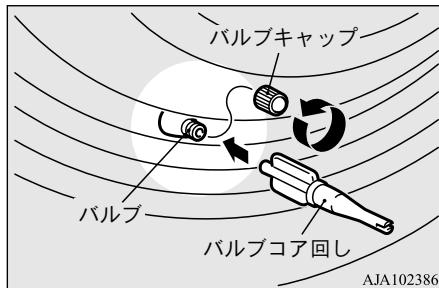
6. バルブコア回しでバルブコアを反時計回りに回して取り外します。取り外したバルブコアは、汚れないよう うちにきれいな場所に保管します。
