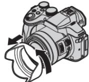
②レンズフードの取り付けマーク（A）を本機底面のマーク（B）からみて少し右側の位置に合わせ、レンズフードをはめ込む
